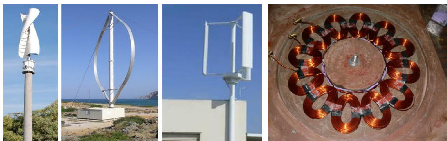
Gambar 3. Savonius, Darrieus dan Giromill dan stator
