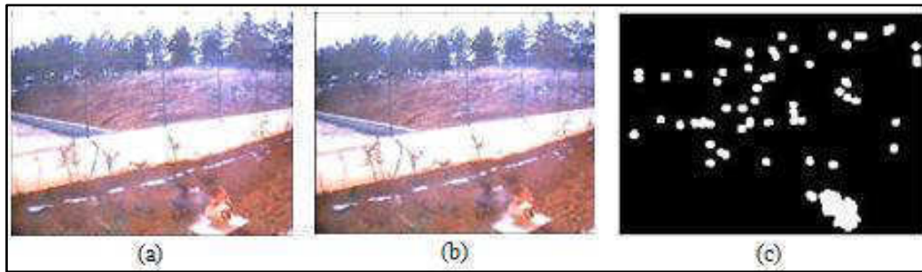
Gambar 3. (a). Frame dari Citra asal (n-1), (b). Frame dari Citra asal (n), (c). Hasil Background Subtraction
