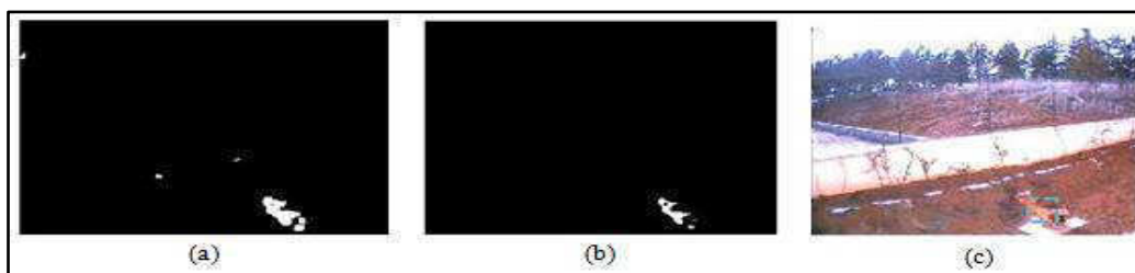
Gambar 5. a. Hasil dari Movement & Color Segmentation Sebelum Proses Morphology, (b). Hasil Segmentasi Setelah Proses Morphology, (c) Hasil Bounding Box area deteksi api dengan citra asli
