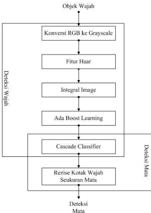
Gambar 4.1 Blok Diagram Sistem Deteksi Mata
