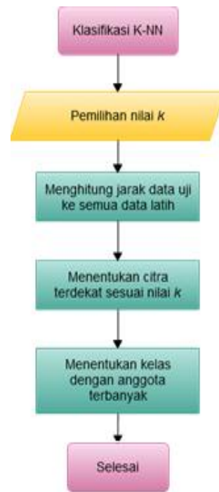
Gambar 26. Flowchart atau diagram alir klasifikasi K-NN
