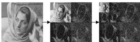
Gambar 7 : Dekomposisi Wavelet Level-3
