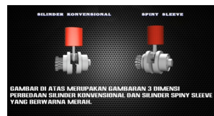
Gambar 57. Perbedaan bagian silinder konvensional dan spiny sleeve
