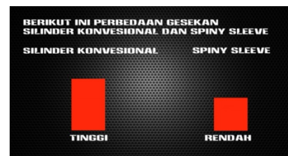
Gambar 65. Perbandingan daya gesekan silinder konvensional dan spiny sleeve
