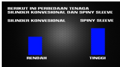
Gambar 66. Perbandingan daya tenaga silinder konvensional dan spiny sleeve.
