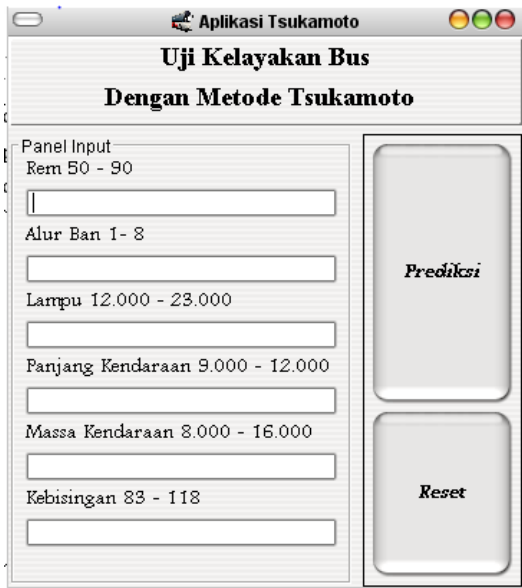
Gambar 3.2 Uji Kelayakan tampilan menu uji kelayakan bus. Didalam menu inilah perhitungan fuzzy dilakukan. Cara melakukan perhitungannya dengan memasukkan input yang tersedia . Adapun input tersebut berupa rem, alur ban, lampu, panjang kendaraan, massa kendaraan dan kebisingan klakson kendaraan.
