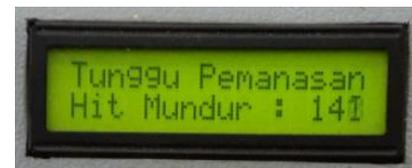
Gambar 4 Tampilan Saat Menunggu Pemanasan Heater Sensor
