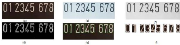
Gambar 36. (a) citra template , (b) citra template hasil invert, (c) citra template hasil grayscale, (d) citra template hasil thresholding, (e) bounding box dari karakter template, (f) hasil crop dan resize karakter
