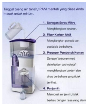
Gambar 1. Komponen alat pemurni air
